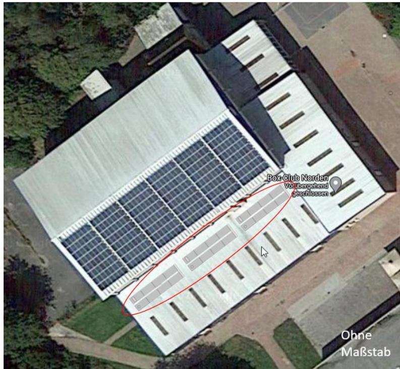
Die mögliche Anzahl der Anlagen auf der Sporthalle wird aktuell mit drei angenommen, da zum einen die statischen Randbedingungen unklar sind und zum anderen die Lichtbänder nicht verdeckt werden sollen (siehe Abb.15). Vom Volumen der Halle und der Heizlast könnten theoretisch bis zu acht Anlagen installiert werden.
