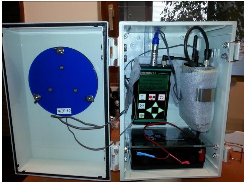
**Abbildung 3: Daueraufzeichnungseinheit mit den Elementen Batcorder, Mikrofonscheibe, 6-V-12Ah-Bleigelakku, Steuereinheit u. Schutzgehäuse.**
