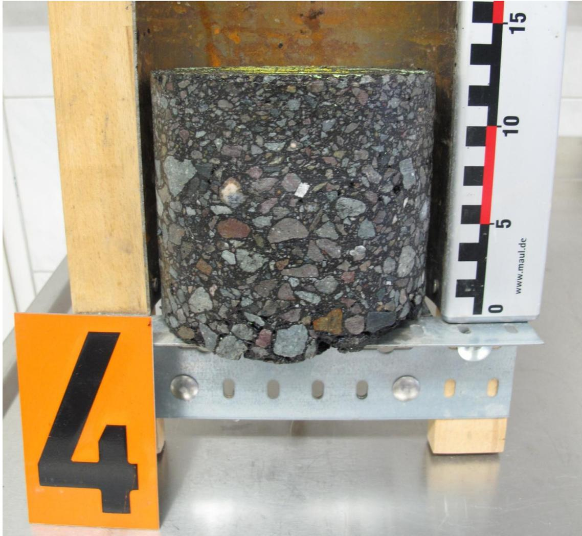
Abbildung 6 Bohrkern BK 03 Oberer Teil; Abgesetzter Fuß- und Radweg
