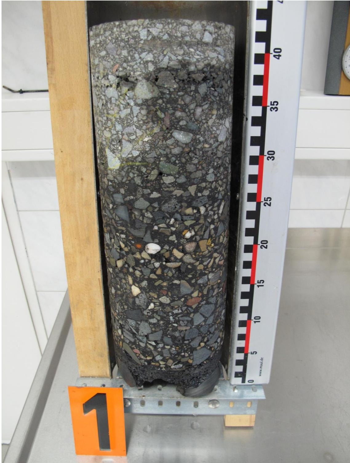
Abbildung 3 Bohrkern BK 01 Fahrbahn B 72
