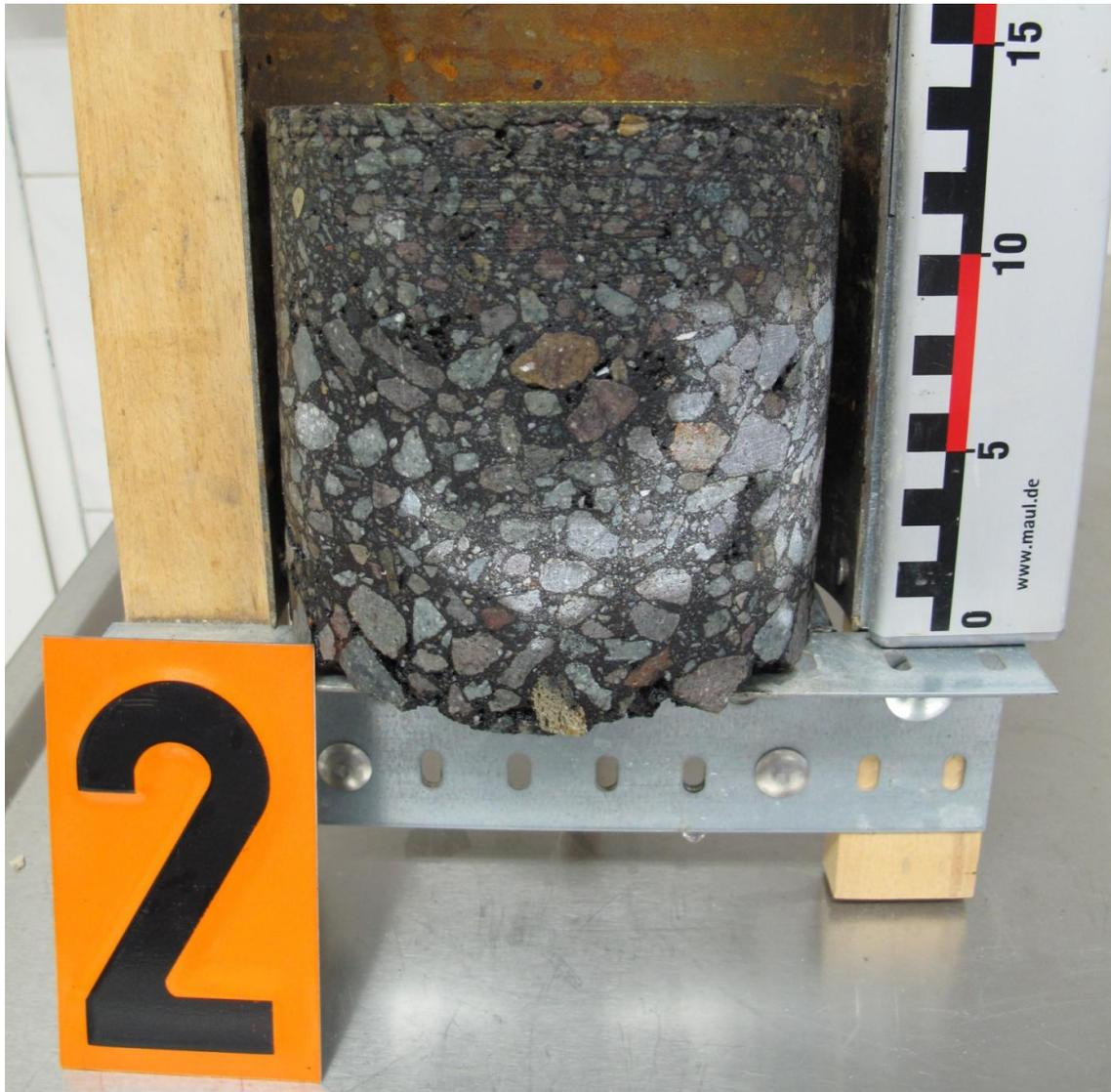
Abbildung 4 Bohrkern BK 02 Oberer Teil; Abgesetzter Fuß- und Radweg
