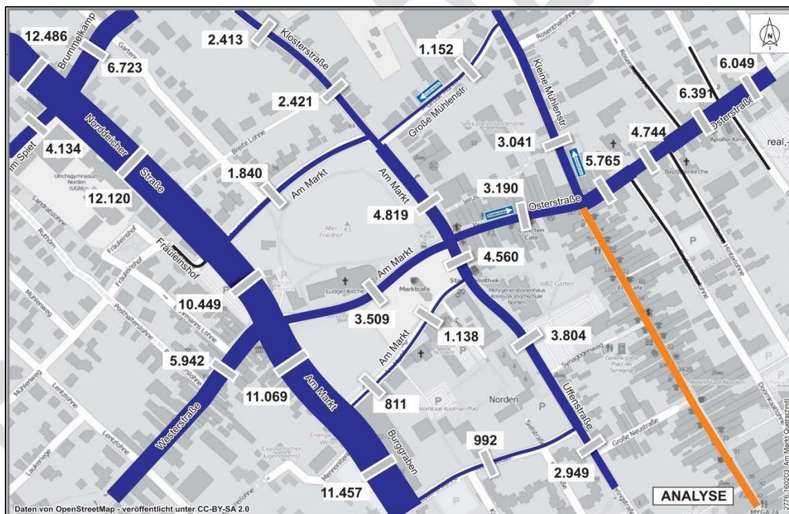
Abb. 3.1: Analyse 2016 Kfz/24h (Erhebung 12/2015)<sup>1</sup>
