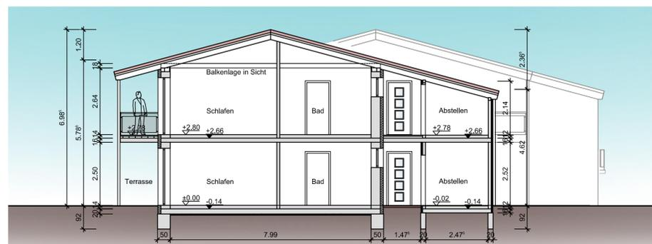
QUERSCHNITT A-A M 1:100
