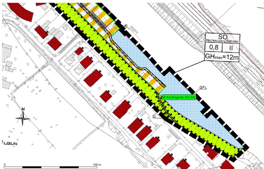
**Abbildung 13:** Darstellung der immissionswirksamen Fläche des B-Plans Nr. 191 mit den ermittelten Emissionskontingenten  $L_{EK}$  (tagsüber/nachts).
