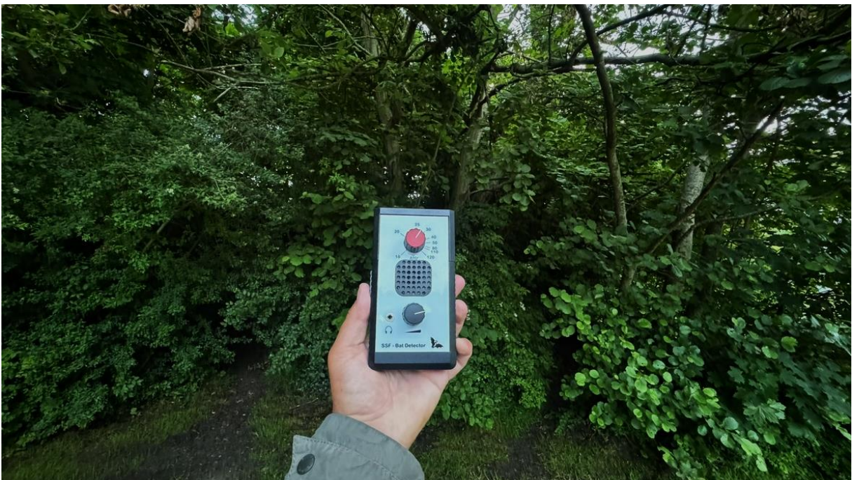
Abb. 9: Einsatz des Fledermaus-Detektors an einer Hecke zur Erfassung möglicher Sozial- und Ortungslaute von Fledermäusen. Aufnahme: 31.05.2024
